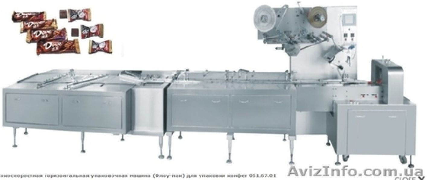
Высокоскоростная горизонтальная упаковочная машина (Флоу-пак) для упаковки конфет 051.67.01
